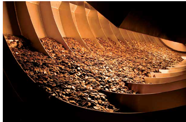
Mit Infrarotlicht gelingt eine Keimreduzierung bei Getreide, Saaten und Cerealien.
